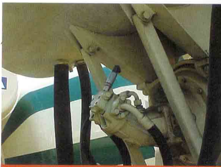
Rilevatore dello slump in autobetoniera
